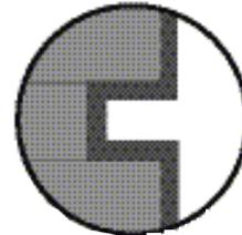
La ilustración de la derecha muestra la uniformidad de los revestimientos "Electroless Nickel", tanto interior como exteriormente.
